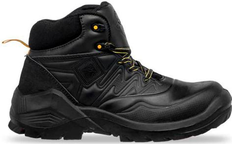
BOTA DIELECTRICA 100% PIEL CON ACABADO 3D DE ALTO RELIEVE, SUELA DE POLIURETANO MONODENSIDAD INYECTADO DIRECTAMENTE AL CORTE. NO PEGADO NI COSIDO. ULTRA LIGERA. ABSORCIÓN DE ENERGÍA EN EL TALÓN Y RESISTENTE A LOS HIDROCARBUROS. CON TECNOLOGÍA ALEMANA, SUELA MOLDEADA PARA EL PIE MEXICANO, LA CUAL AYUDA A EVITAR FATIGA EN LA JORNADA DE TRABAJO, CON PLANTILLA PREFORMADA CON PUNTOS DE LIBERACIÓN DE PRESIÓN Y AYUDA A LA CIRCULACIÓN.
